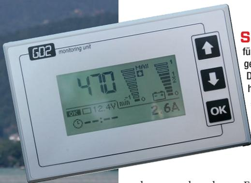
**Sauber.** Der Bordcomputer für den E-Antrieb zeigt alle wichtigen Daten in übersichtlicher Form. Die Akkus sind hier noch mehr als halb voll, der Motor dreht auf „Standgas“ mit 470 U/min und verbraucht dabei 2,6 A
